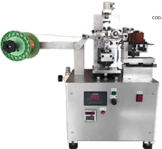
**Eurohook** sostituisce un'operazione che normalmente viene fatta manualmente, ovvero quella di preparare il filo dove vengono agganciati i pezzi sui telai della galvanica.
