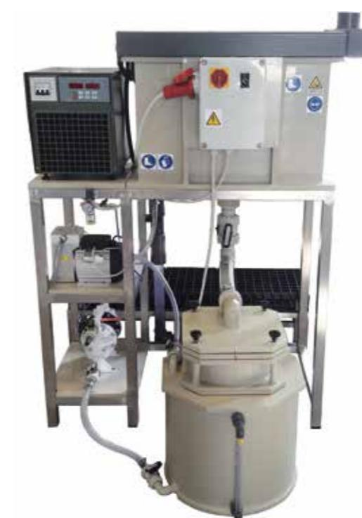
L'impianto di recupero oro è costituito da una vasca collegata ad un raddrizzatore in cui si versa la soluzione contenente l'oro che si desidera recuperare. Il passaggio di corrente consente all'oro di restare attaccato alle barre catodiche presenti all'interno della vasca. Il liquido esausto viene fatto fluire nel recipiente sottostante, ed eventuale oro rimanente viene raccolto da un filtro. Una volta che il recipiente è pieno viene svuotato con l'ausilio della pompa a membrana.
